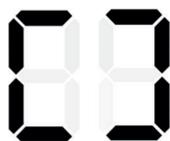
Чтобы активировать функцию обнаружения открытых окон, удерживайте кнопку таймера на панели управления в течение 5 секунд. Два звуковых сигнала означают, что функция включена, один звуковой сигнал означает, что функция выключена.
