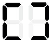
Щоб активувати функцію виявлення відкритих вікон, утримуйте кнопку таймера на панелі керування протягом 5 секунд. Два звукових сигнали означають, що функція увімкнена, один звуковий сигнал означає, що функція вимкнена.
