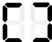
Per attivare la funzione di rilevamento delle finestre aperte, tenere premuto il pulsante del timer sul pannello di controllo per 5 secondi. Il cicalino suona due volte per indicare che la funzione è attivata e una volta per indicare che la funzione è disattivata.
